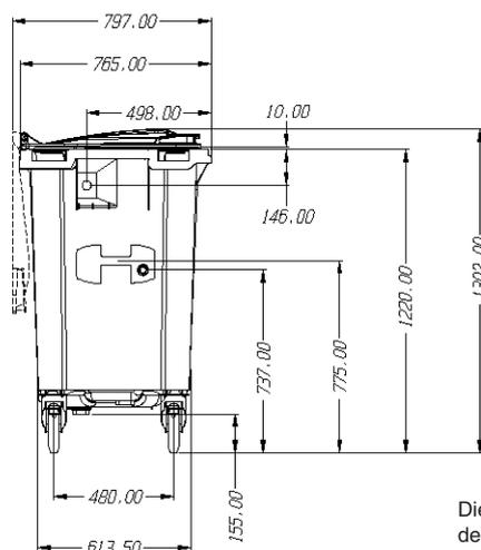
Diese Abmessungen unterliegen den in der Norm EN 840-1:2012 festgelegten Toleranzen.
